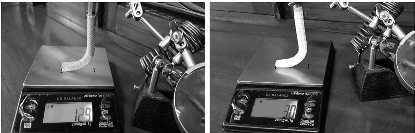
**Figura 3.** Medición de la fuerza axial de los 2 *stents*, siendo tres veces mayor en el *stent* convencional sobre el *stent flower* (12,9 vs. 3,0).
